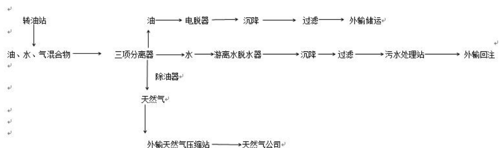
图 3-1-2 大庆油田第六采油厂第三油矿喇 560 联合站工艺流程图
